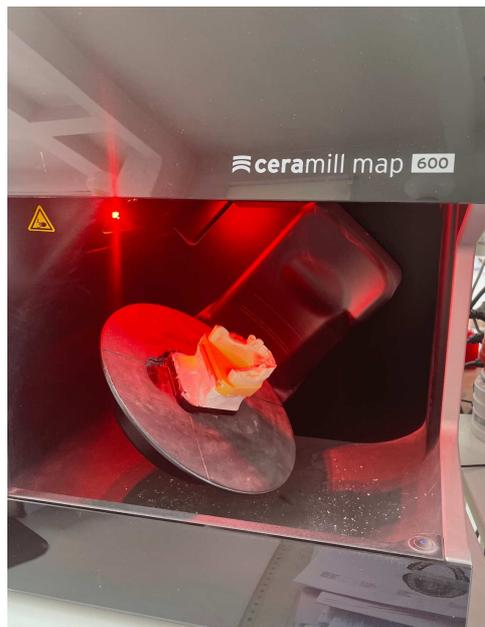
*Figure 19 : Photographie personnelle Ceramill Map 600 pour scanner les modèles en plâtre en format numérique*
