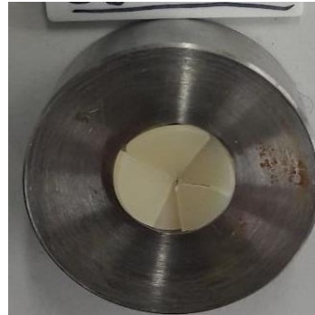
Figure 19. Echantillon GRA8 après fracture par flexion bi-axiale
