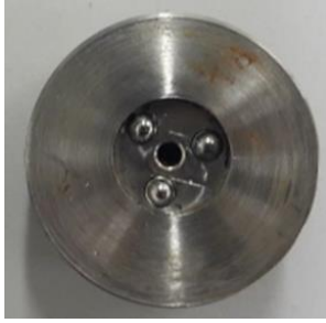
Figure 15 Cellule du support de l'échantillon avec 3 billes en acier
