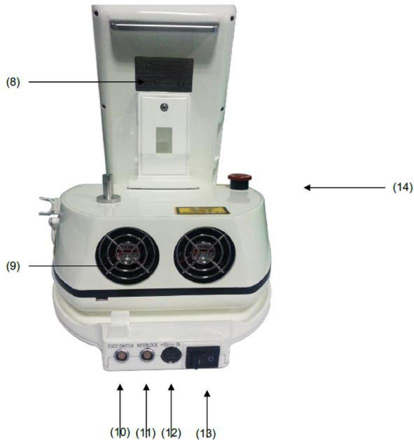
**Figure 38 : Illustration de la face arrière de l'appareil "Cheese II" (12) (8) Ecran d'affichage, (9) Ventilateur, (10) Prise pour la pédale, (11) Système de sécurité à distance qui peut être connecté à la porte de la salle, (12) Prise d'alimentation électrique, (13) Principal interrupteur, (14) Bouton d'arrêt d'urgence.**
