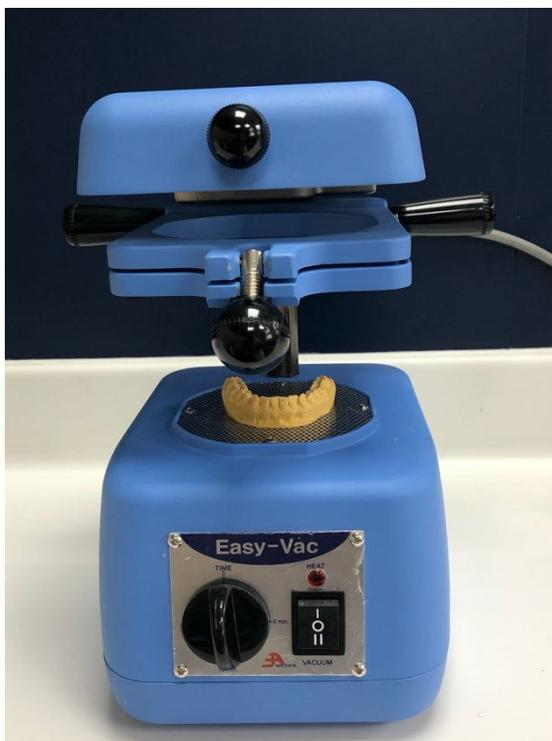
Figure 10 : Thermoformage de la gouttière (image personnelle)
