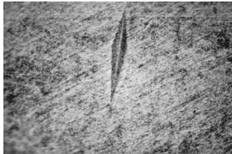
*Figure 5: Microstructure de lime en acier inoxydable après 40 cycles de stérilisation [26].*
