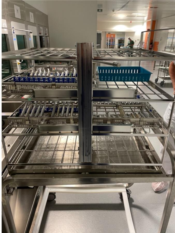
**Figure 21 : Photographie de la charge à la sortie du laveur désinfecteur chargé avec des paniers à embases pour porte instruments dynamique (Source personnelle)**
