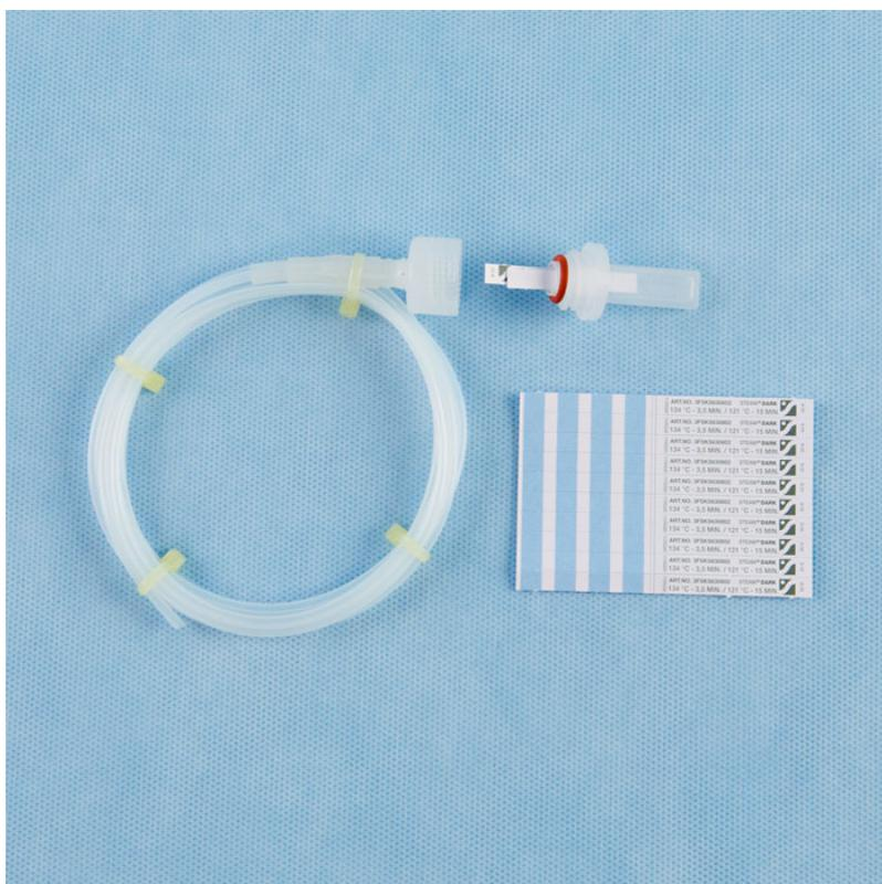
**Figure 13 :** Photo d'un system pour la réalisation de test Hélix [45].
