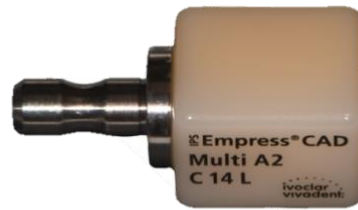
Figure 5 : Bloc de vitrocéramique enrichie en leucite [contribution personnelle].
