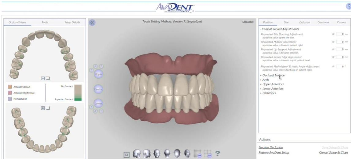
Figure 56 : Proposition du montage par le logiciel Avadent Connect® (26)
