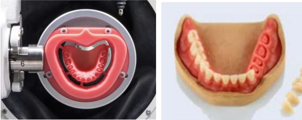
Figure 45 Usinage de la base en cire et des alvéoles (21)
