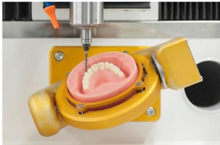
Figure 57 : Usinage du disque XCL2 (25)
