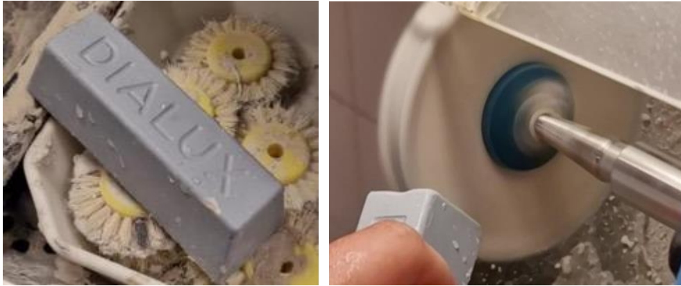
Figure 58: Application de la pâte à brillantage DIALUX® sur le disque à polir. Iconographie personnelle.
