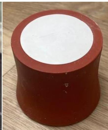
Figure 19: Coulée du revêtement pour la mise en cylindre. Iconographie personnelle.
