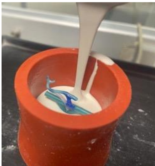
Figure 19: Coulée du revêtement pour la mise en cylindre. Iconographie personnelle.
