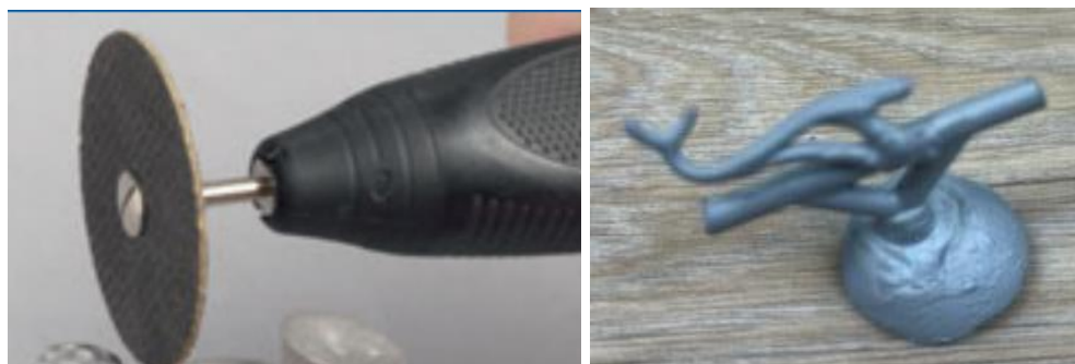
Figure 23: Disque à tronçonner (à gauche) ; crochet métallique relié à la pièce de coulée avant découpe (à droite). Iconographie personnelle.
