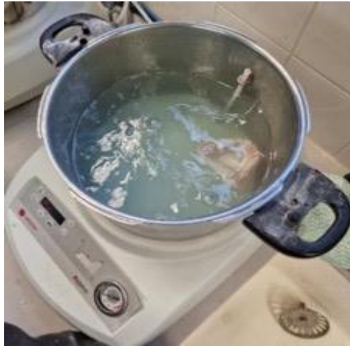
Figure 54: Polymérisation d'une PAPIM dans une cocotte automatique à 45°C pendant 6 minutes. Iconographie personnelle.
