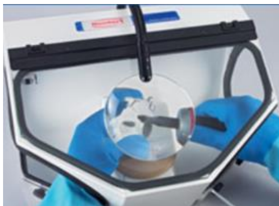
Figure 22: Démoulage et grattage dans un box de grattage [14].
