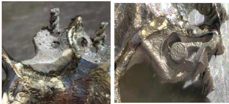
Figure 72: Grille de rétention après soudure laser sur l'infrastructure métallique. Iconographie personnelle.
