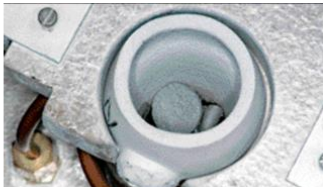
Figure 21 : Mise en place de l'alliage dans le creuset. Iconographie personnelle.
