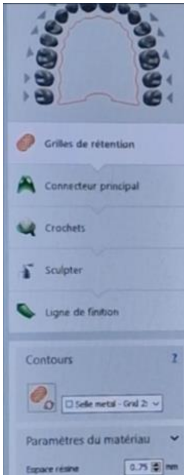
Figure 62: Représentation de la séquence de conception numérique de plaque métallique sur le logiciel de CFAO. Iconographie personnelle.
