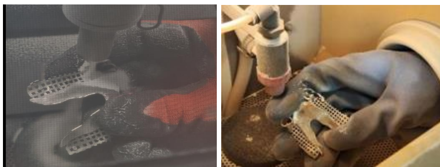
Figure 43: Sablage de la pièce prothétique. Iconographies personnelles.
