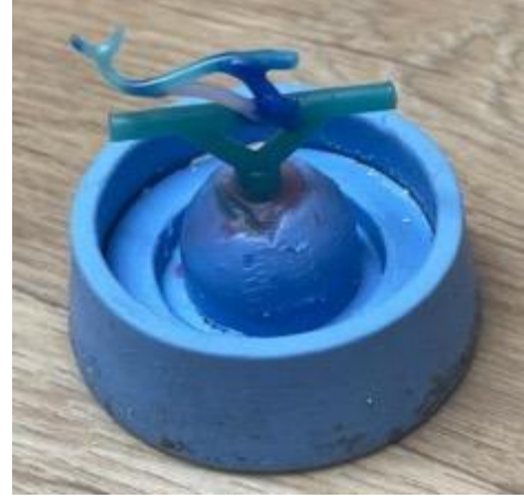
Figure 18: A gauche, mise en place des canaux de coulée et de l'entonnoir de coulée pour une PAPIM [14].; A droite, mise en place des canaux de coulée et de l'entonnoir de coulée pour un crochet Roach. Iconographie personnelle.
