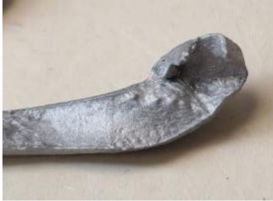
Figure 28: Réalisation d'un « cran » qui forme une zone de rétention qui va faciliter le positionnement du crochet au niveau de la grille métallique. Iconographie personnelle.
