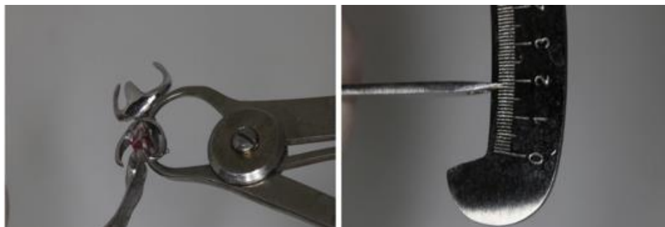
Figure 78: (A gauche) Mesure de l'épaisseur du métal du cadre dans la zone d'interférence avec les étriers ; (A droite) On vérifie qu'il y ait plus d'1,5mm d'épaisseur de métal [25].
