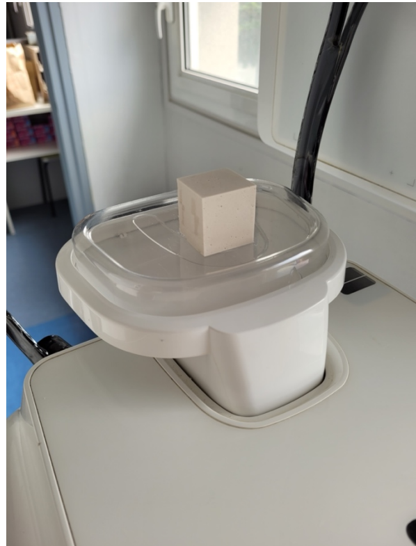
Figure 24 : Échantillon (plâtre) positionné sur le plateau VATECH® dans le cone beam, vue de ¾ face [photographie personnelle]
