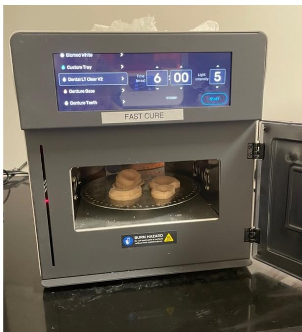
Figure 24 : vue des modèles dans le four à photopolymériser (illustration personnelle).
