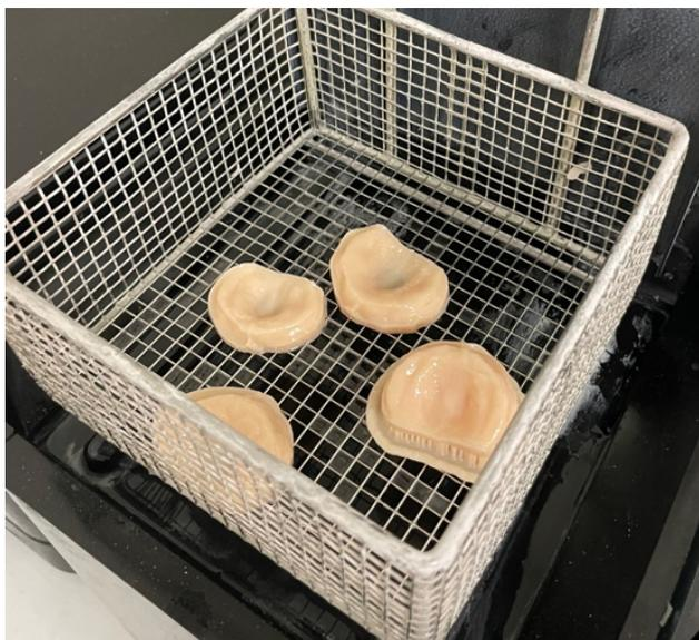
Figure 23 : vue des modèles avant insertion dans le bac d'alcool isopropylique (illustration personnelle).
