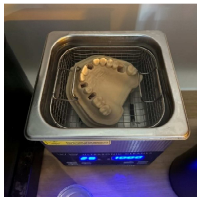
Figure 81 : iconographie illustrant le deuxième bain de rinçage dans l'alcool isopropylique propre pour le modèle maxillaire avec grossissement (iconographie personnelle).
