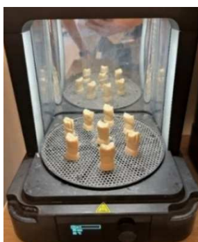
Figure 82 : iconographie illustrant le four FormCure® de chez Formlabs® utilisé pour photopolymériser les pièces imprimées en 3D (iconographie personnelle).
