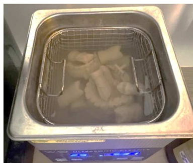
Figure 80 : iconographie illustrant le premier bain de rinçage dans l'alcool isopropylique (propriété personnelle).
