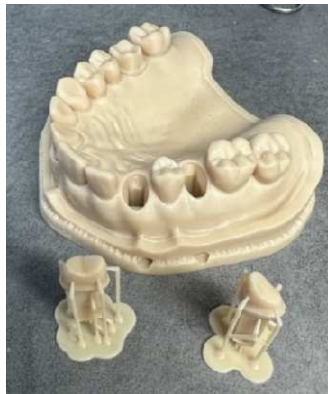
Figure 84 : modèle pédagogique maxillaire et ses MPU en sortie d'étape de photopolymérisation (iconographie personnelle).
