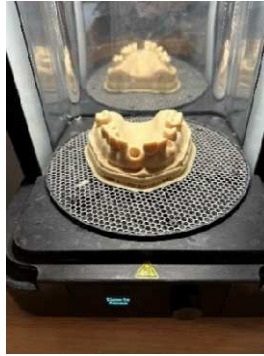
Figure 83 : four utilisé pour polymériser les pièces imprimées en 3D après traitement du maxi modèle maxillaire (iconographie personnelle).
