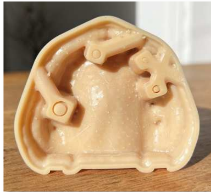
Figure 91: dessous du modèle après impression montrant la présence de boutons poussoirs afin de faire sortir les MPU des modèles pédagogiques (iconographie personnelle).
