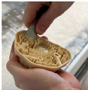
Figure 85 : suppression des piliers connectant le modèle au fond de la cuve d'impression (iconographie personnelle).
