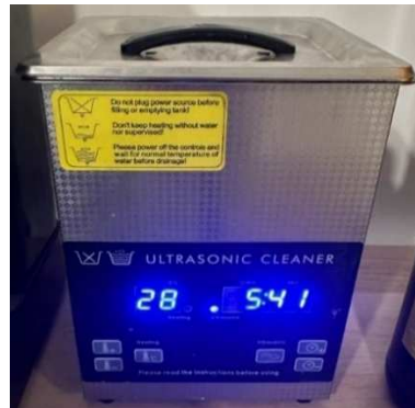
Figure 79 : bac de rinçage à ultrasons rempli d'alcool isopropylique (1 er bain) (propriété personnelle).
