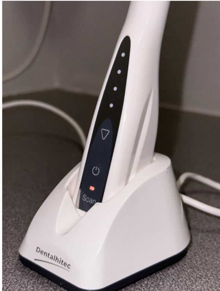
*Figure 41 : Photographie personnelle du SOAN sur sa station avec le voyant orange indiquant que la batterie est en cours de chargement.*
