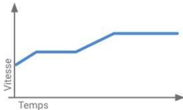
*Figure 46 : Vitesse d'injection du mode Lo en fonction du temps sur le SOAN, la vitesse d'injection est plus lente et progressive que la vitesse du mode Hi (84).*
