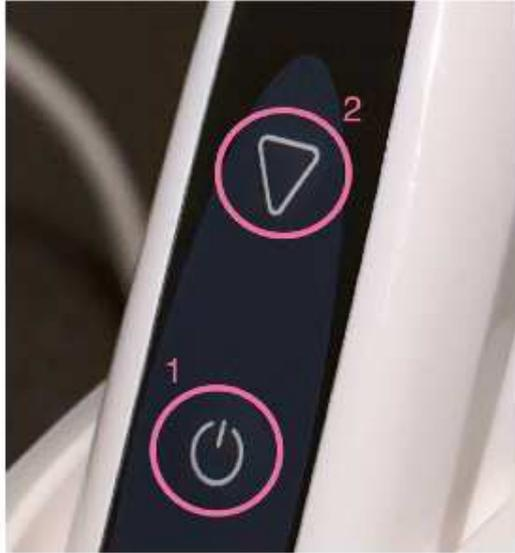
**Allumer la pièce à main (1) et vérifier le retour du piston en position «0» avec le bouton de retour piston (2)**
