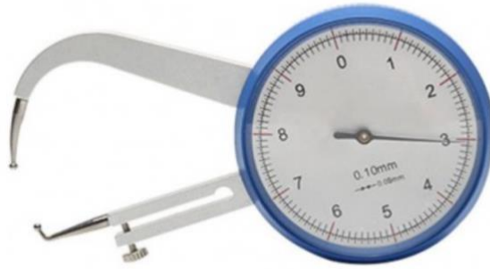
Figure 34 : compas d'épaisseur analogique [78]
