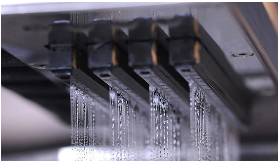
Figure 23 : photographie des buses d'éjection de liant [58]
