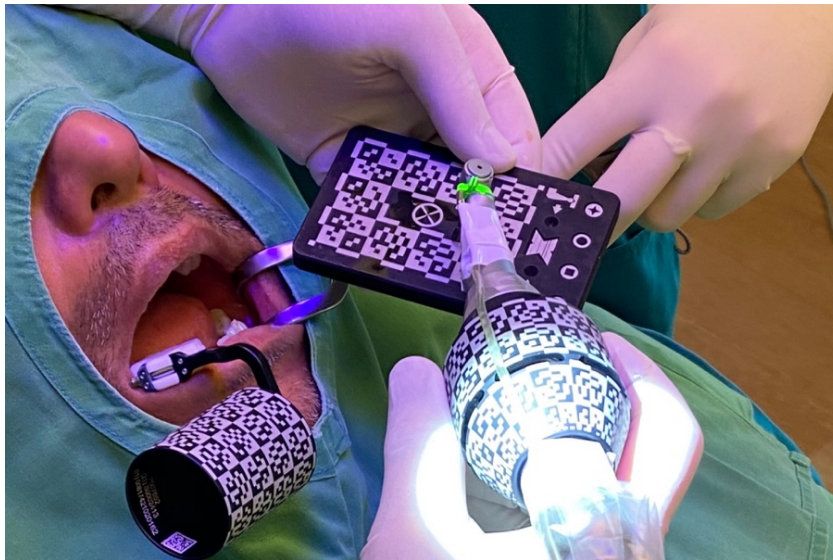
Figure 7 : Tracker monté sur le contre-angle qui présente le foret au système à l'aide de la Go-Plate [8].
