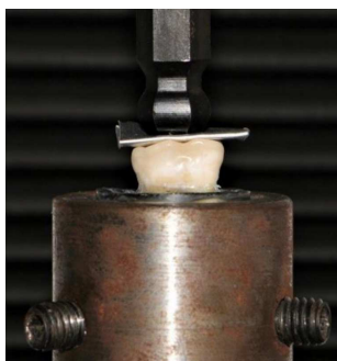
Figure 7 : machine universelle pour les tests de résistance à la fracture [33].
