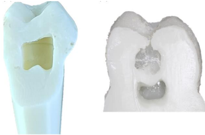
Figure 26 : Photographie présentant la coupe longitudinale d'une dent 85 Frasaco standard (à gauche) et de la dent développée imprimée en 3D (à droite) (43).
