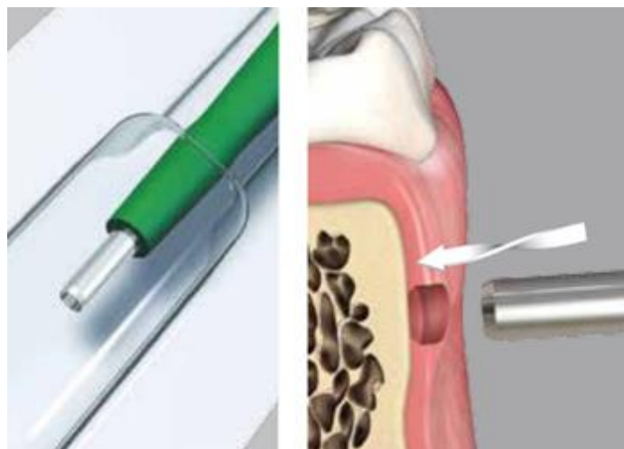
Figure 45: schéma d'un mucotome et de son utilisation(57)
