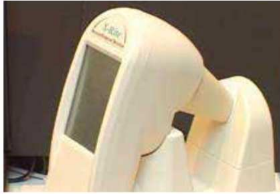
Figure 8 : Colorimètre modèle ShadeVision (X-Rite) [3].
