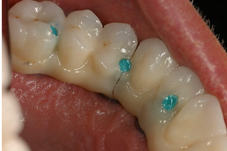
Figure 14 - Photographie endobuccale d'une fracture de l'armature en zircone d'une reconstitution fixe implanto-portée (courtoisie Dr Modaine)
