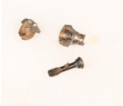
Figure 46 - photographie du pilier MUA angulé en 34 fracturé (courtoisie Dr Modaine)
