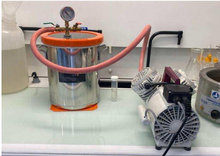
Figure 5 : Photographie d'une cloche sous vide reliée à un compresseur
