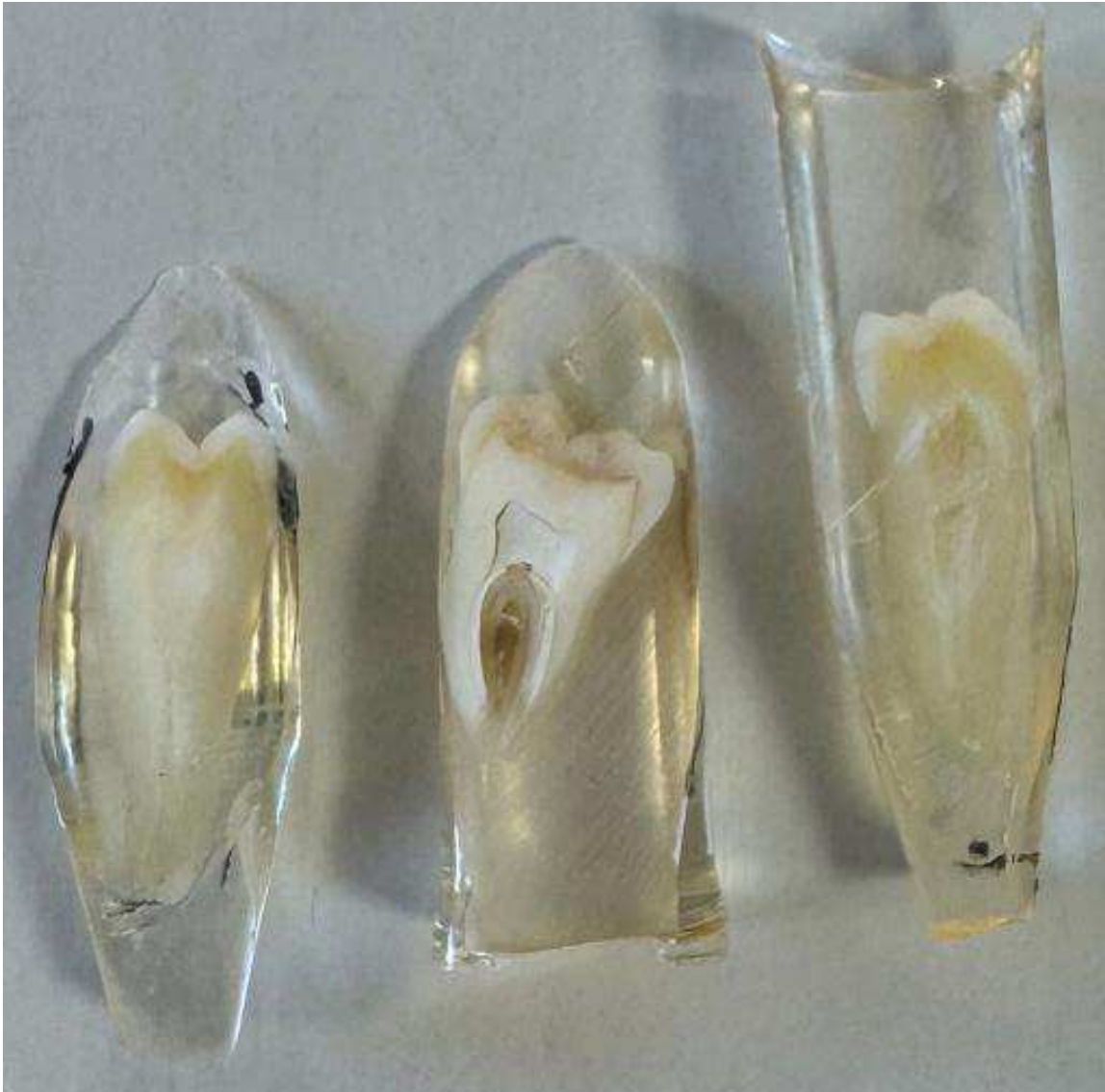
Figure 9 : photographie d'échantillons dentaires après découpe grâce à une disqueuse permettant de mettre en évidence une zone d'intérêt
