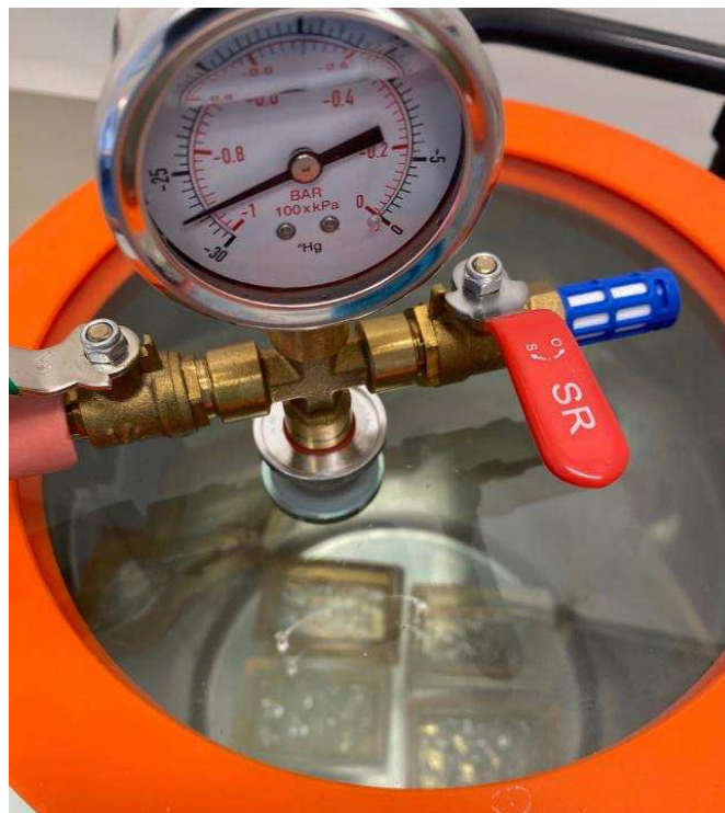
Figure 6 : Photographie d'échantillons en inclusion dans une cloche sous vide
