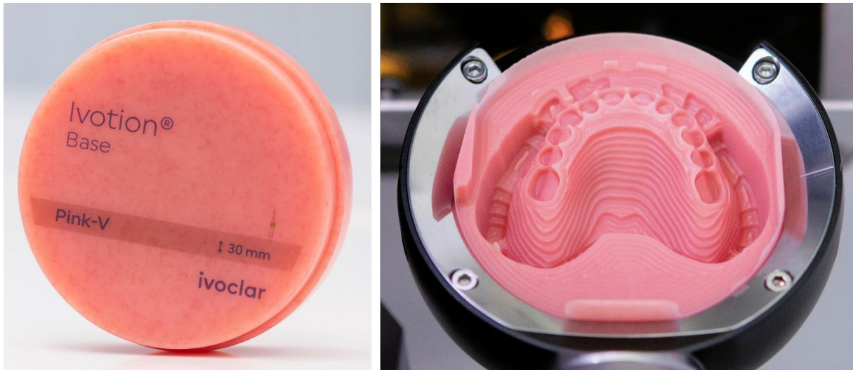
Figure 2 : usinage d'une base prothétique dans un bloc de résine monochrome Ivotion® Base. Bloc résine rose (image de gauche), base résine fraisée dans le bloc avec logements des dents (image de droite). (Capture d'images de site Internet) 4 .
