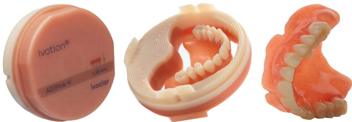
Figure 4 : usinage d'une base associée à des dents prothétiques dans un disque bicolore. Bloc résine bicolore (image de gauche), base et dents fraisées dans le bloc (image du centre), prothèse terminée (image de gauche). Ivotion®(capture d'images de site Internet) 6 .
