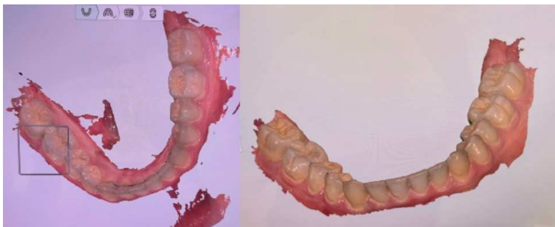
Figure 2 : nettoyage des artéfacts par l'algorithme lors d'une prise d'empreinte sur le logiciel 3Shape® (iconographie personnelle).
