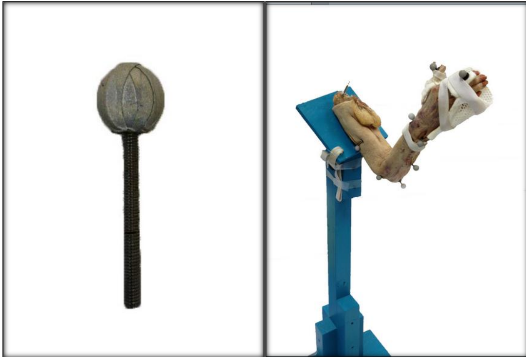
Figure 17 : Montage des capteurs réfléchissants sur une tige filetée
