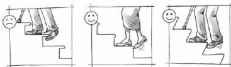
Figure 4: Schématisation des nez de marche
