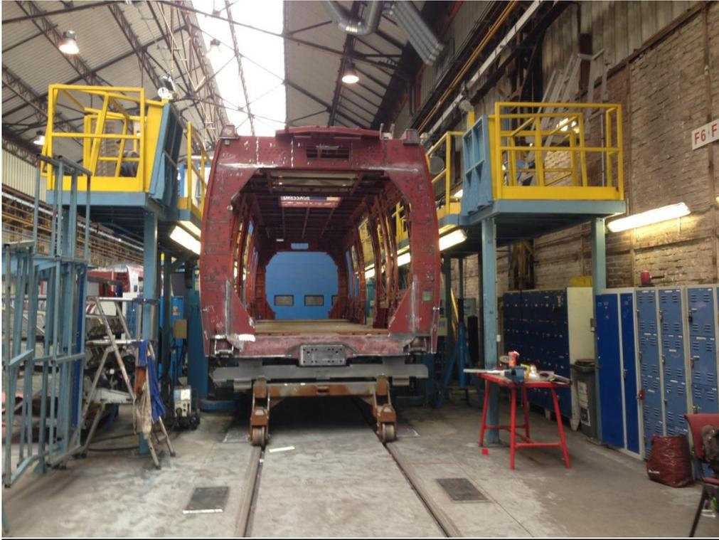
*Figure 7 : vue de face d'une caisse*
