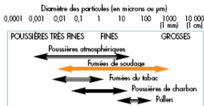
*Figure 1 : Dimensions des particules en suspension dans l'air (1)*
