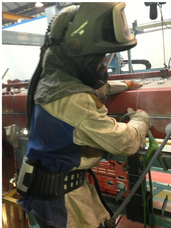
*Figure 10 : Cagoule à aduction d'air d'un soudeur*
