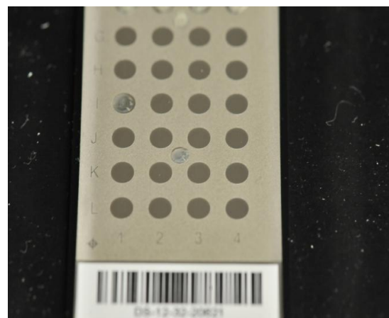
Figure 31: dépôt de matrice
