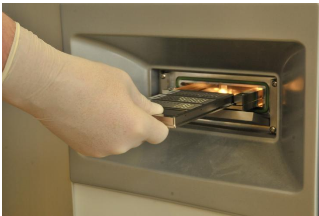
Figure 32: insertion du support de plaque dans l'automate VITEK MS®.
