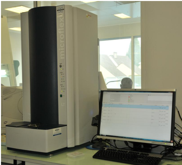
Figure 11: spectromètre de masse BRUKER et son unité informatique.
