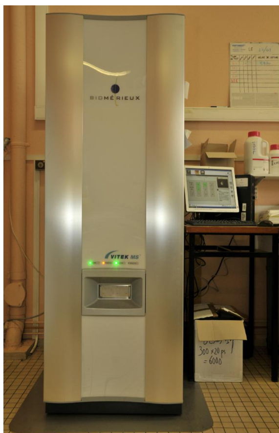
Figure 16: spectromètre de masse VITEK MS® et son unité informatique.
