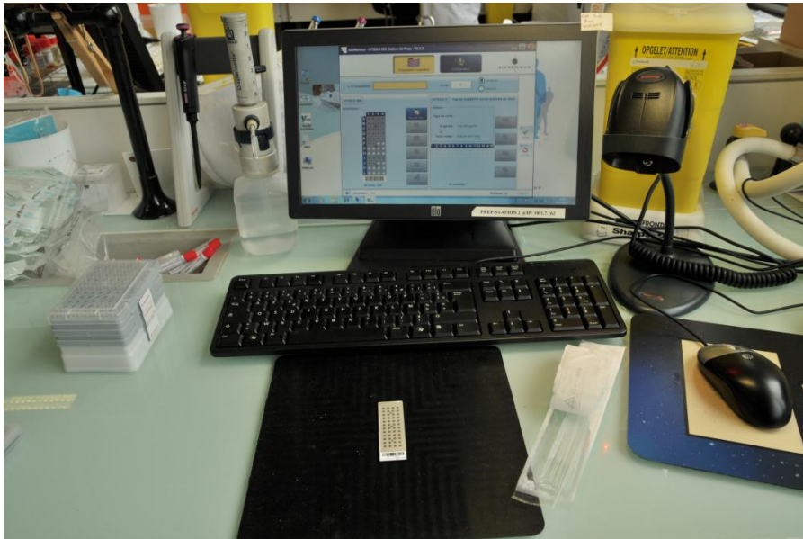
Figure 17: organisation de la paillasse de travail pour une analyse VITEK MS®.
