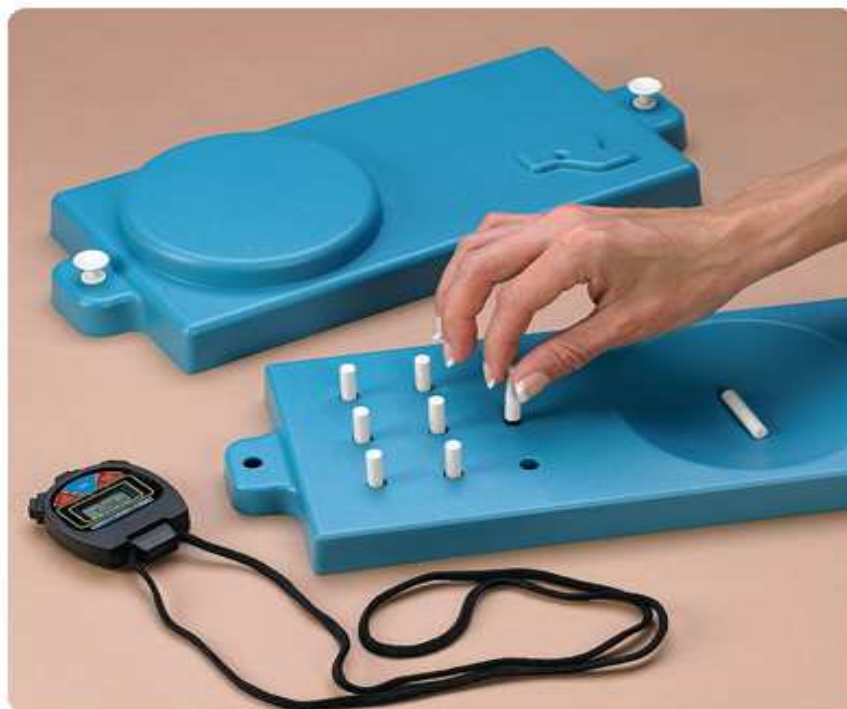
Figure 2 : Test des 9 chevilles
