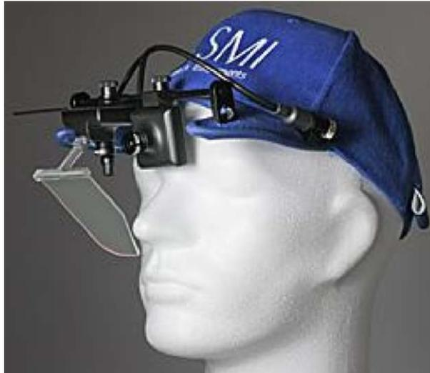
**Figure 26** : L'oculomètre (*iViewX HED*) est fait d'une caméra filmant ce qui se passe en avant du sujet, d'une seconde caméra mesurant le reflet infrarouge de l'œil, le tout fixé sur une casquette. La fréquence de rafraîchissement est de 50Hz.
