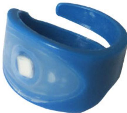
Figure 22 : Photographie d'une bague TLD
