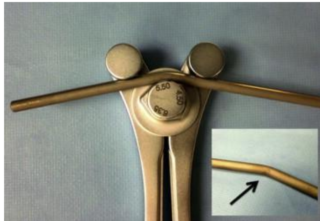
Figure 37 Flèche noire : zone de fragilité liée à l'action du « french bender »
