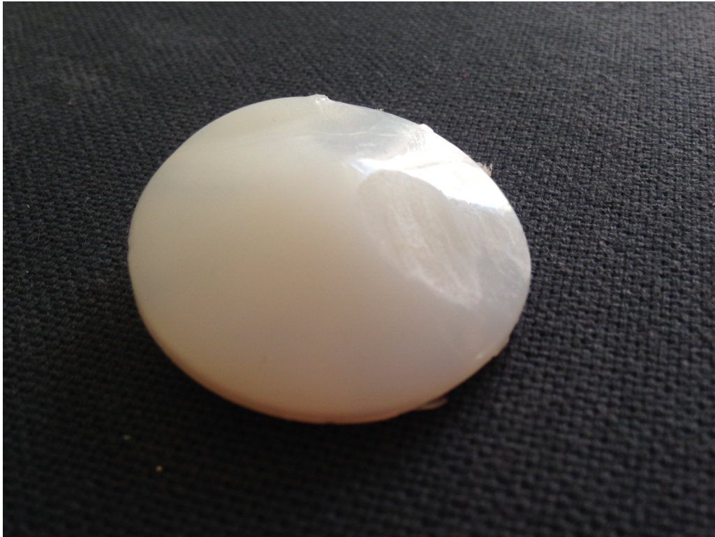
Fig 77. Exemple d'un polyéthylène déposé par le Pr G.PASQUIER témoignant d'une usure anormale au dépend de sa face externe à 2 ans de l'implantation (PFP Zimmer)
