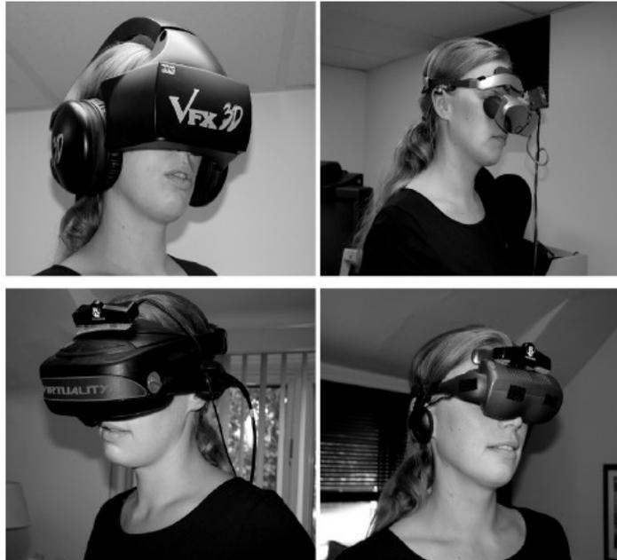
*Photos de différents visiocasques (ou HMD = Head-Mounted Display en anglais) – in « Virtual Reality Applications for Exposure (Bouchard et al., 2006) »*
