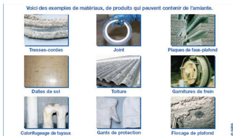
Figure 1 : Exemples de produits contenant de l'amiante (56)
