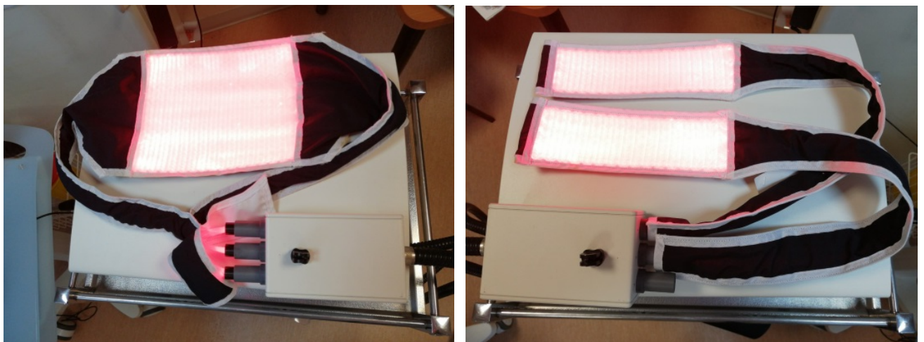
Figure 12: Dispositifs textiles lumineux FLUXMEDICARE : à gauche, TEXTLIGHT 1 (traitement du scalp) ; à droite, TEXTLIGHT 3 (traitement des tempes) – Service de Dermatologie CHU Lille
