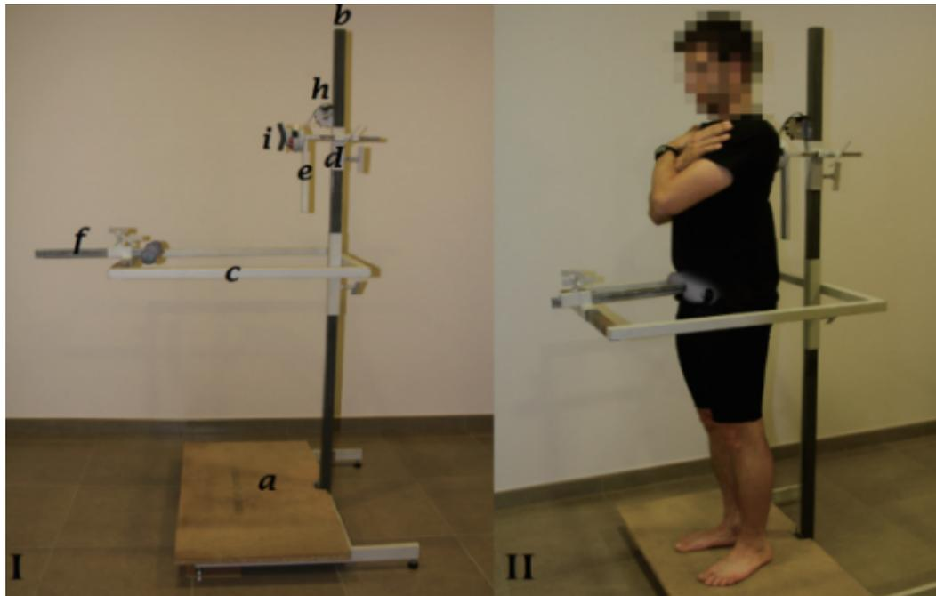
Support en acier démontable avec dynamomètre intégré (Jubany et Al.)
