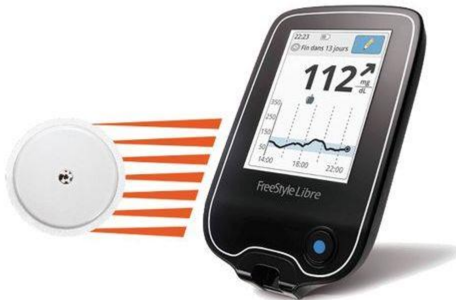
Figure 4 : Dispositif Freestyle Libre (capteur et lecteur)
