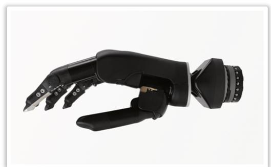
**Figure 3.F :** prothèse de main myoélectrique iLimb Ultra Ossur®
