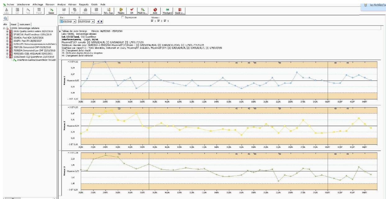
**Figure 43 : Courbes de Levey-Jennings pour les trois niveaux de CQI du test sur le logiciel URT. Niveau 1 : contrôle bas ; niveau 2 : contrôle medium ; niveau 3 : contrôle haut (199).**
