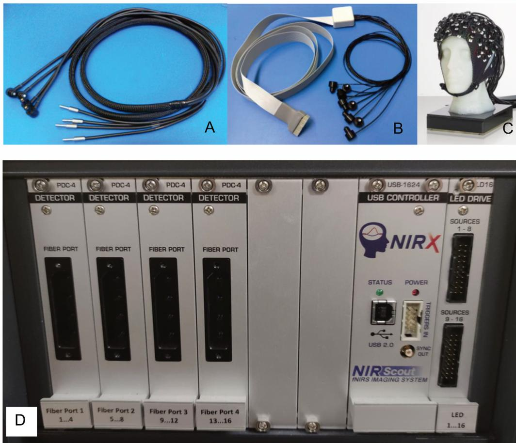
Figure 19 : **Dispositif NIRScout**. A : détecteurs et leurs câbles de raccordement ; B : sources LED et leurs câbles de raccordement ; C : casque NIRScaps, où sont positionnées les optodes ; D : amplificateur avec les différentes pistes pour détecteurs et sources (d'après NIRX NIRScout User Manual).
