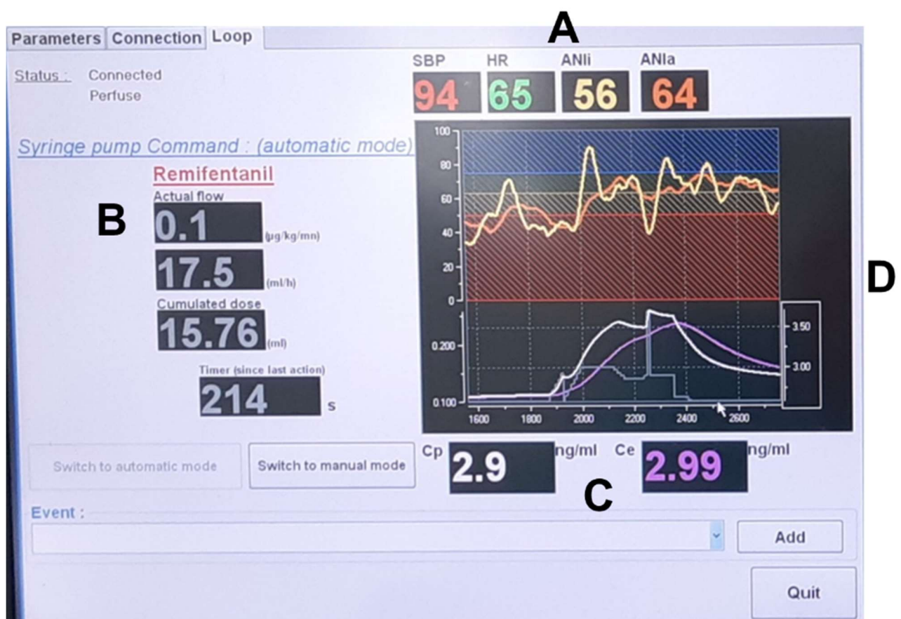
Figure 5.1 : Interface graphique du DM ANI-REMI-LOOP®. Affichage des paramètres recueillis (A), du débit instantané de rémifentanyl (B) et des concentrations plasmatique et cérébrale théoriques (modèle de Minto) (C). L'affichage des tendances renseigne sur l'évolution des indices ANI a , ANI i et du débit massique au cours du temps (D). (SBP : Systolique Blood Pressure, HR : Heart Rate, Cp : Concentration plasmatique, Ce : Concentration cérébrale)
