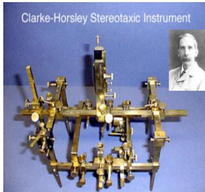
Image 6 : Cadre stéréotaxique de Clarke et Horsley, développé en 1906
