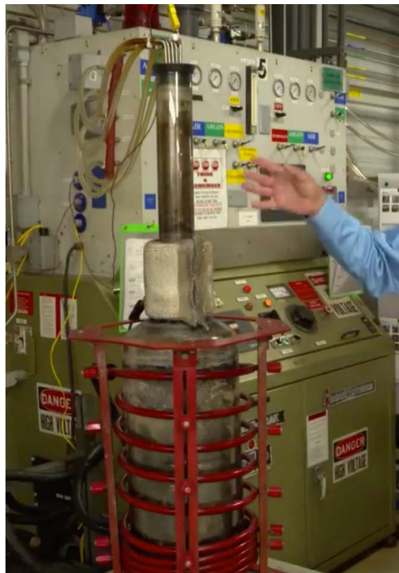
Figure 11 : Dispositif utilisé pour la fabrication du trabecular metal
