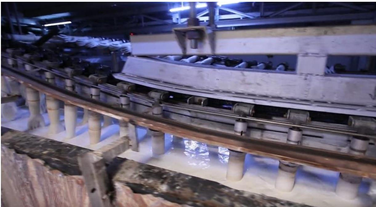
**Figure 7 : Plonger des formes en porcelaine dans un bain de latex centrifugé.**
