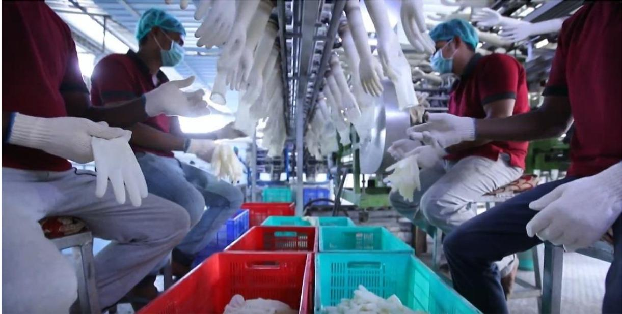
**Figure 13 : Ouvriers démoulant les gants de leurs supports.**
