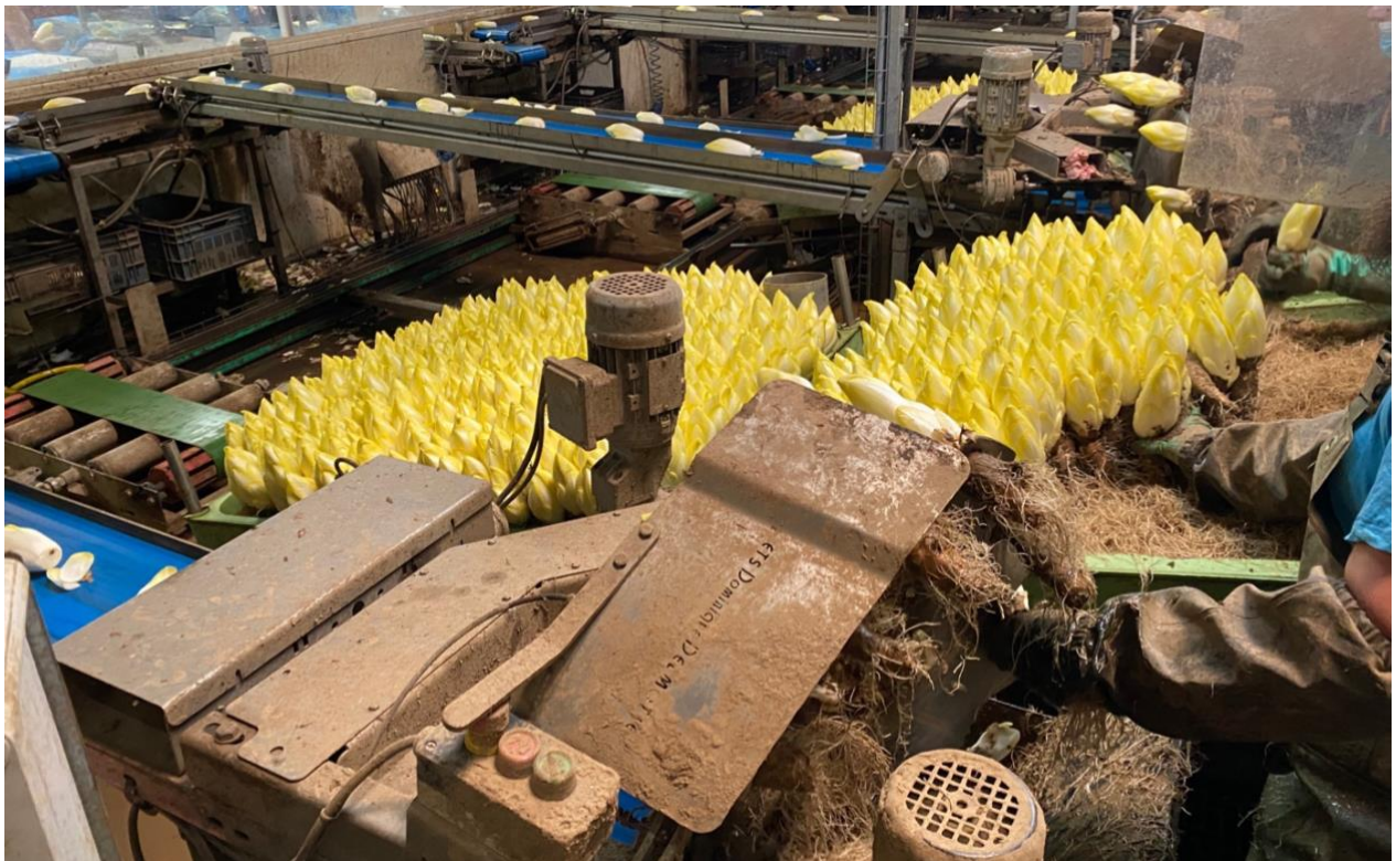
Figure 33 : Poste de cassage, en arrière-plan on peut voir les endives sans racine être transportées vers la zone d'épluchage.
