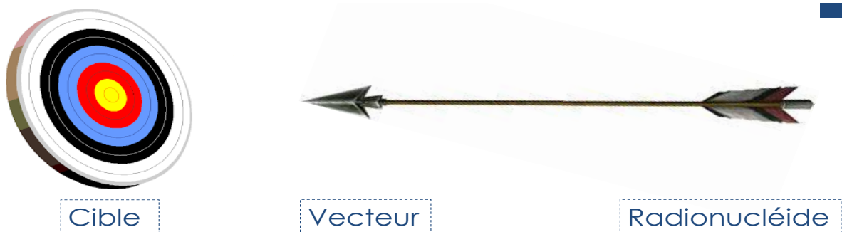
Figure 1 : Le radiotraceur peut être schématisé comme tel, avec un vecteur qui aura une affinité pour une cible (organe, fonction) et un radionucléide qui permettra de le repérer
