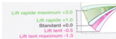
Figure 27. Possibilité de modification du dégagement, ou Edge-Lift (document Menicon)
