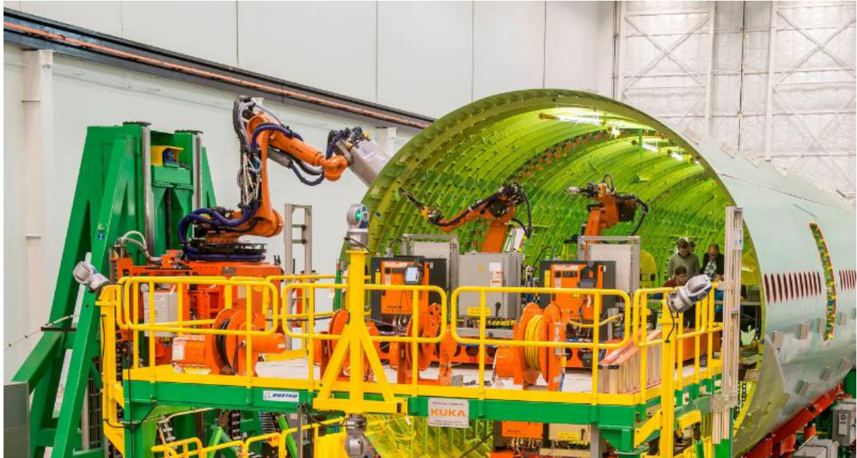
Figure 2 : Automatisation d'une chaîne de production d'avions (robots industriels à bras articulés KUKA)
