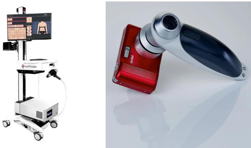
Figure 9. A gauche exemple d'un FotoFinder®. A droite un dermoscope Dermogenius II couplé à un appareil photo.
