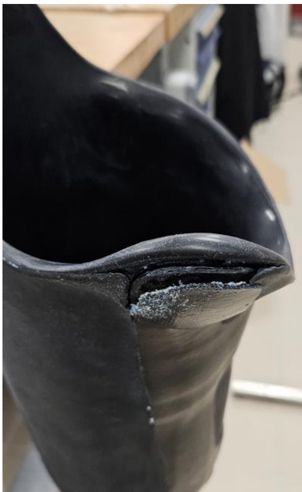
Figure 26. Déchirure au niveau de la transition entre la partie rigide en carbone et la zone souple en silicone.
